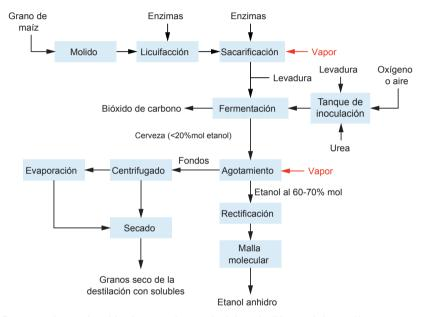
Figura 15. Proceso de producción de etanol a partir del maíz (Karuppiah et al.)
