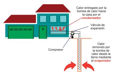
Figura 24. Bomba para calentar una casa mediante una fuente geotérmica somera.
