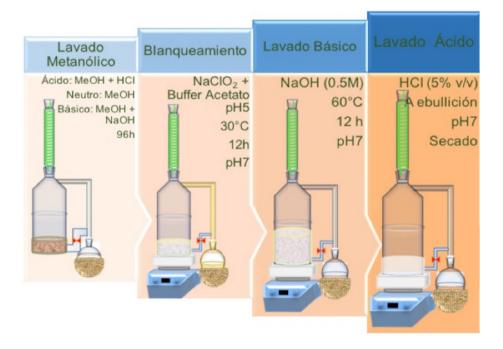
Figura 2. Sistema continuo de reacción/ extracción para la separación/ purificación de celulosa.
