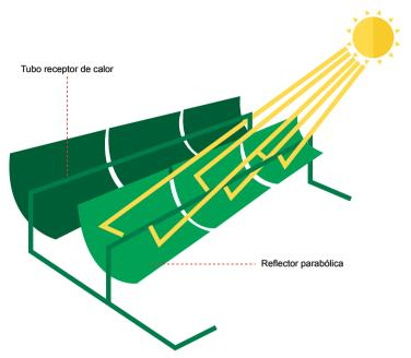
Figura 19. Sistema térmo-solar con concentradores parabólicas
