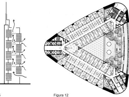
Figura 5 Corte esquemático que muestra el sistema de ventilación e iluminación (Arquitecto: Norman Foster, 1991-1997. Dibujo: Archivo M. Rodríguez).
