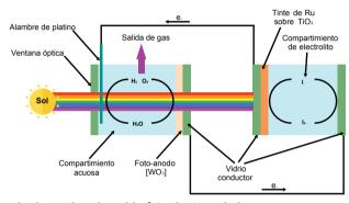
Figura 13. Ejemplo de un tipo de celda fotoelectroquímica
