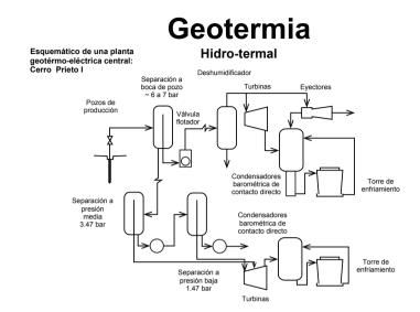
Figura 23. Proceso de generación eléctrica a partir de la geotermia en Cerro Prieto, Baja California.
