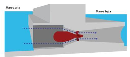
Figura 6. Sistema de turbina con barrera para formar una balsa marítima
