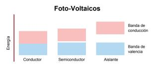
Figura 12. Funcionamiento de fotovoltaicos
