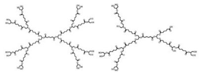
Figura 1. Posibles estructuras de dendrímeros del ácido adípico-glicerol obtenidas por síntesis enzimática con la lipasa YLL2-Lewatit. Las condiciones de reacción son: mezclas equimolares de sustratos en t-butanol, 50°C, 48 h.
