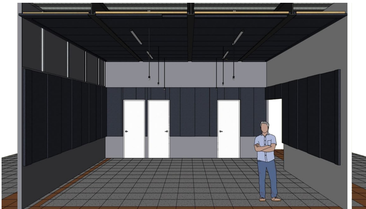
Esquema 3: vista final de la colocación de los paneles acústicos en muros y techo
